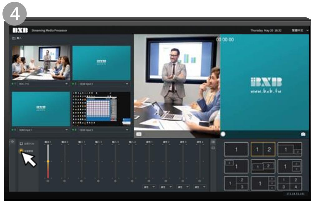
開啟「全部靜音」模式時，八組輸入音源頻道將被強制關閉。此時，八組輸入音源無法開啟並調整音量。
