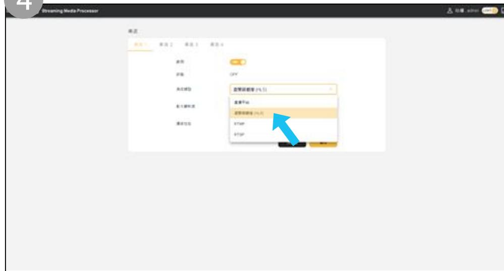
狀態顯示當下是否為串流中。狀態「ON」代表串流中，此時無法變更串流設定；狀態「OFF」代表無串流執行，可修改串流相關設定。
